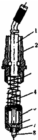
Рис. 3.7. Пусковое устройство карбюратора К-65: 1 - шток; 2 - направляющая; 3 - пружина; 4 - пробка плунжера; 5 - плунжер; 6 - шайба стопорная; 7 - шайба уплотнительная; 8 - игла
